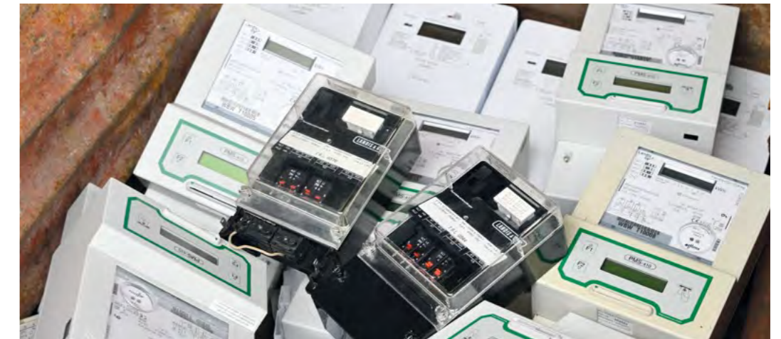
Die IBL plant bis Ende 2027 die gesetzlich vorgegeben 80 % der konventionellen Stromzähler in ihrem Versorgungsgebiet durch Smart Meter – insgesamt rund 10'000 Stück – zu ersetzen. Den Termin für den Zählerwechsel erhalten die Kundinnen und Kunden rechtzeitig per Post.
